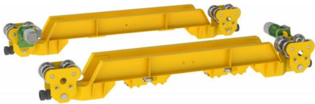
Современные концевые балки мостового крана оснащаются приводами с обеих сторон, благодаря этому движение крана стало более стабильным и ровным. Высота и длина концевых балок зависит от пролета, грузоподъемности и вида крана. В подвесном варианте одна из балок плавающая, это позволяет сократить износ крановых колес и избежать неровности подкрановых путей.
