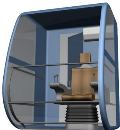
Для непосредственного управления грузоподъемным краном применяют кабины управления. Конструкция кабины управления грузоподъемным краном и место ее установки должны обеспечивать крановщику беспрепятственный обзор и видимость рабочей зоны крана от момента захвата груза, включая момент освобождения от него, соответствовать требованиям ГОСТ 12.2.066–81 и гарантировать безопасную работу на кране.
